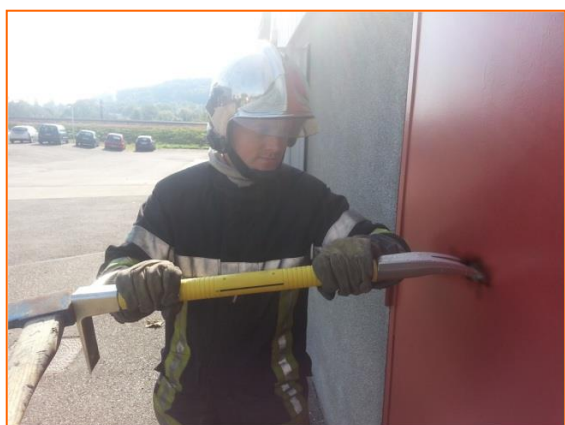
3. Engager la fourche en frappant avec la masse (ou hache)
