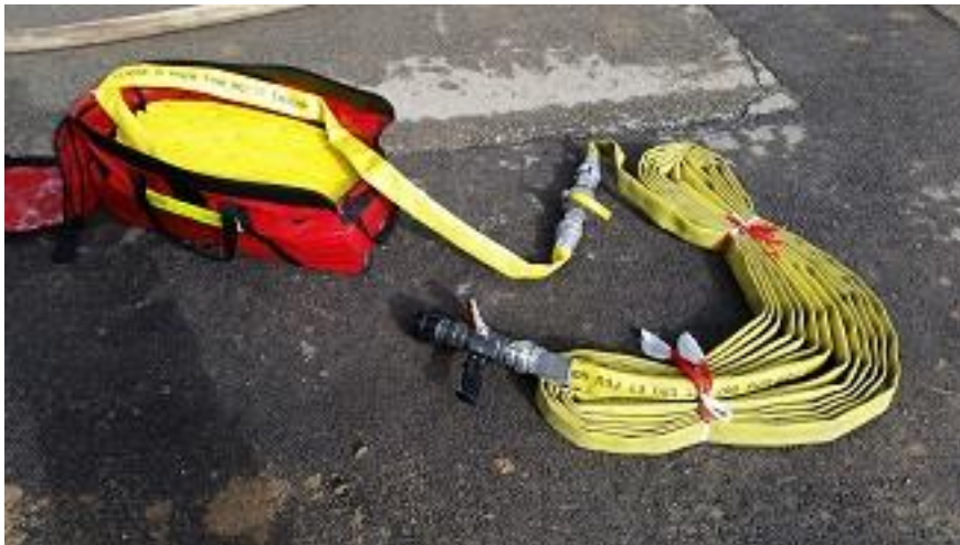
Sac d'attaque (3 tuyaux dont le dernier en O, avec utilisation d'une vanne d'arrêt)
