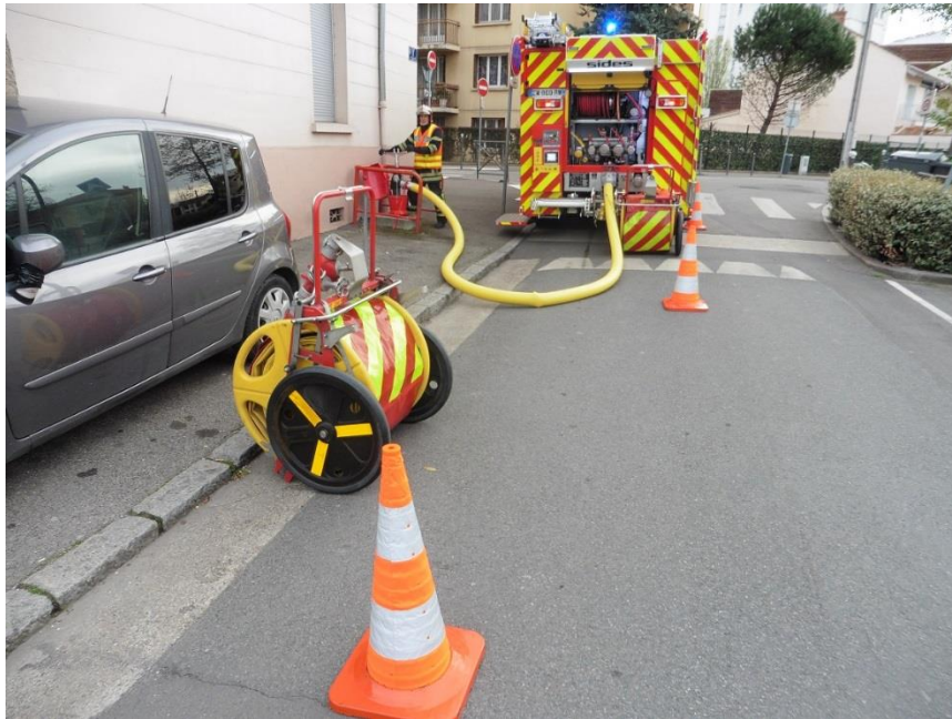
Illustration n°1 : alimentation d'un engin pompe à l'aide d'un tuyau de 110 (Crédit photo @ SDMIS 69)
